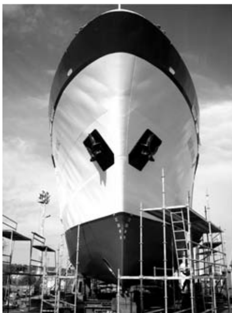
Slika 5. Završni radovi bojenja podvodnoga dijela trupa
